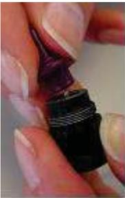
Pour positionner l'embout de sonde, dévissez et retirez le capuchon de la sonde et positionnez l'embout de sonde dans le logement de la sonde.
