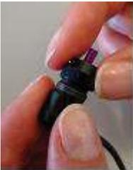
Vissez le capuchon de la sonde pour fixer l'embout en position et bien le serrer.
